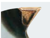
Steltitierter Zahn im Plasma-Schweißverfahren
